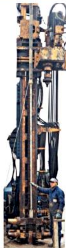
Wiercenie przy pomocy penetrometru i wiertnicy
